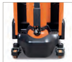
Due rulli di supporto laterali caricati a molla per un'eccellente stabilità di guida e in curva
