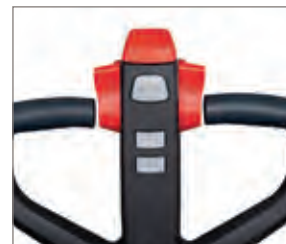
Comodo controllo di velocità, direzione di marcia e frenata tramite interruttori a bilanciere di facile utilizzo. Pulsanti grandi e facilmente accessibili per alzare e abbassare forcella. Fornito di cacson
