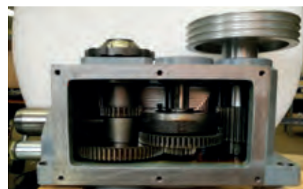
Scatola ingranaggi in bagno d'olio.
