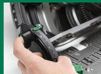
Doppia regolazione dell'inclinazione (da  $-1^{\circ}$  a  $46^{\circ}$ ), accuratezza e precisione al top.
