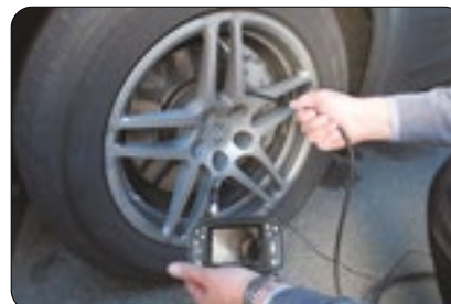
Esempio: Controllo delle pastiglie dei freni
